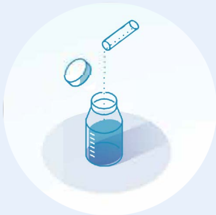
1.将试剂与100mL水样混合
