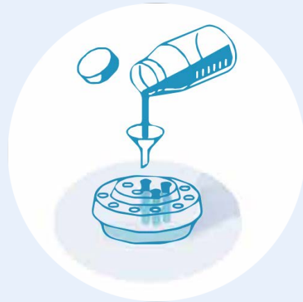
2.将混合后样品倒入MPN分析仪中
